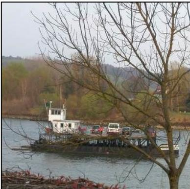
Eine Rollfähre braucht keinen Antrieb, denn sie funktioniert mit der Strömung und durch das Stellen des Ruderblatts (soweit der Satz für die Schiffsbauer). Die Rolle hängt hoch über dem Fluss an einem Seil, das die Schiffe nicht
